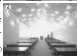
①ひるぜんジャージーランドビジターセンター全景 ②同上 ③蒜山酪農農業協同組合の製品を主に使用する、100人収容可能なフランス料理レストラン ④交流ホール。コストを考慮して、天井には一番安い蛍光灯をランダムに直付けした。
