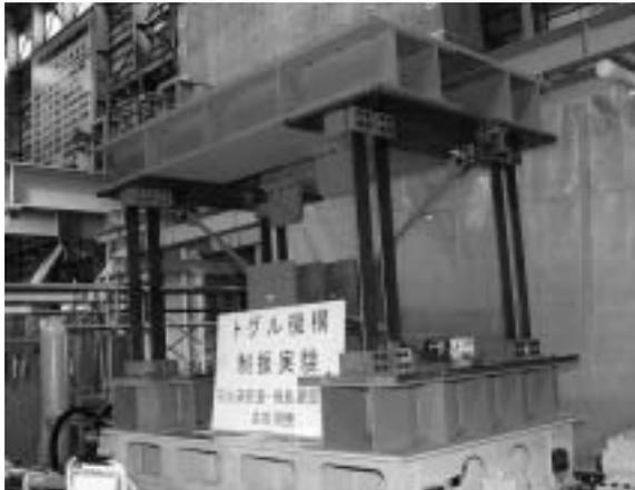
す。われわれはこのような現状を踏まえ、既存の建物にも適用可能で、あらゆる振動（地震動、風揺れ、交通・機械振動など）に対して優れた安全性と居住性を確保するための制振機構（写真）を提案し、それに関する基礎研究を行いました。この機構は“てこ”と“補助質量”を組み合わせ、それを建物に組み込むことで躯体に入力する地震エネルギーを低減できるという理論を具現化したものです。
