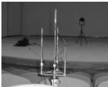
反射音が4つのマイクを通過する時間差を検出して到来方向を測定できます。上の解析例もこれで測定したものです。
