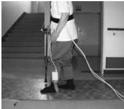
高齢者に対する住宅床の快適性・安全性の研究 床仕上げ構造の変化に伴う足裏の圧力分布を測定し，歩行特性を明らかにする
