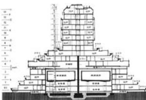
図 1 アウトバーン上に建つ集合住宅の断面
