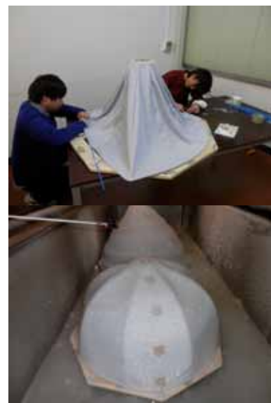
上：膜模型の制作風景。 下：膜体に水を散布しながら、アイスドームを制作していく。
