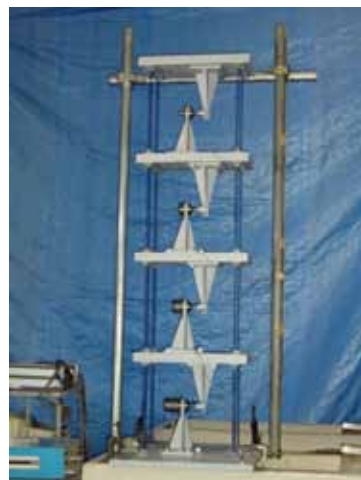
ダイナミックマスによるモード制御実験の試験体。
