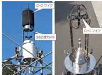
左:「音ジャッジ」の監視用センサー。右:方向判別するC-Cマイク。(写真=大林組HPより)
