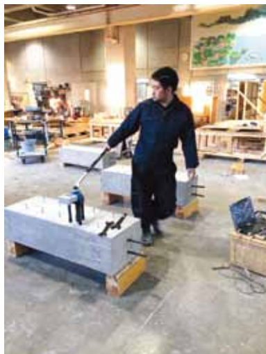
卒業研究の実験で、アンカーボルトの引き抜き試験を行っているところ。試験体のコンクリートの作製から実験まで、全て自分たちで取り組んだ。
