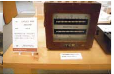
1953年に製作された横河電機製作所製「商用周波数用の共振振動子形周波数計」は、実際に電源を入れて試せるようになっている。
