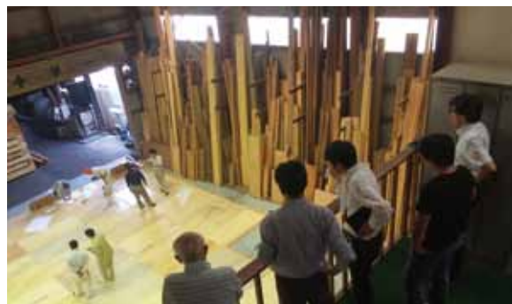
福岡の寺院の庫裡の設計で、宮大工とともに、屋根をかたちづくる破風のラインやバランスを原寸で確認しているときの写真。設計者、施工者、建築主が一同に介している現場。
