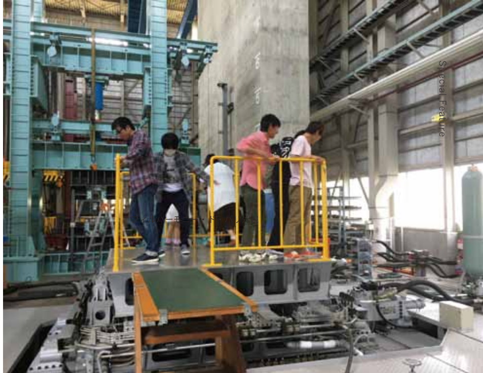
大型構造物試験棟：多入力振動試験装置に乗って過去の巨大地震を体感
