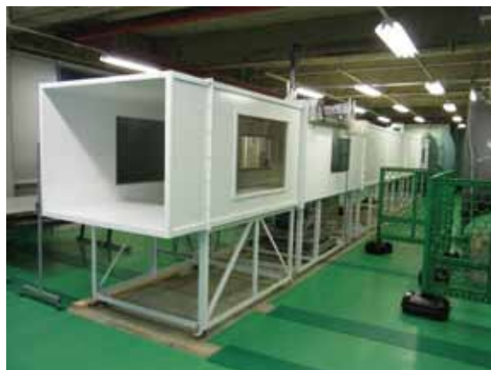
建築風洞実験室：エッフェル型風洞試験装置によりスタジアムのフィールドの風環境を計測中
