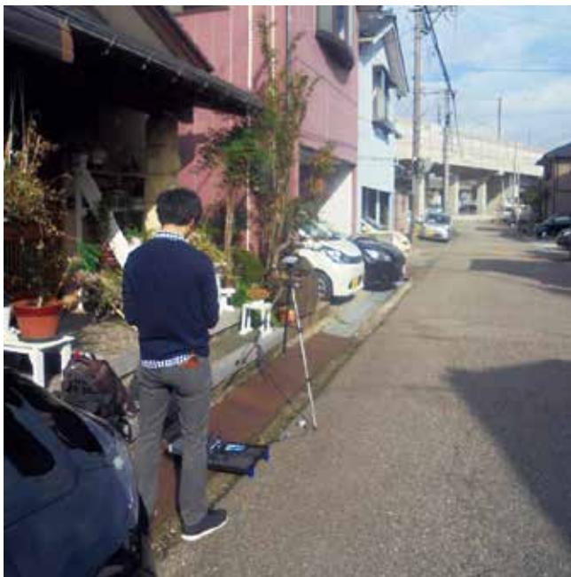
新幹線沿いの住宅で環境振動を測定している様子
