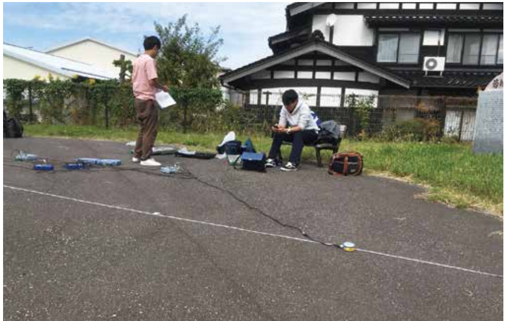
北陸新幹線による振動伝搬測定。
