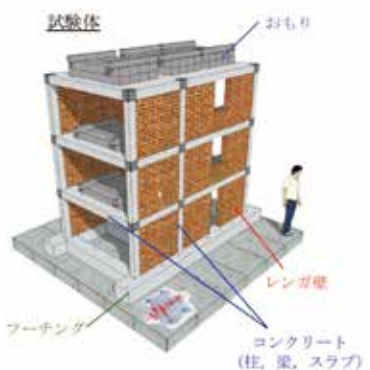
レンガ壁付きRC造骨組みの試験体。
