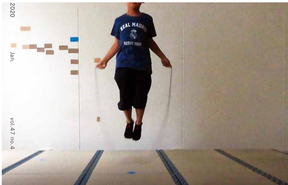
畳付き収納家具の床衝撃音測定。
