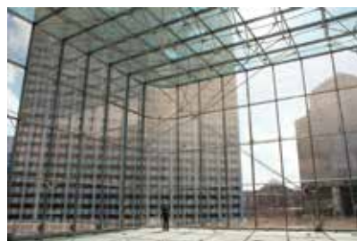
繊細な柱・梁・テンションネットシステムで支えられた透明感あふれるガラス空間（シンガポールの商業施設）。
