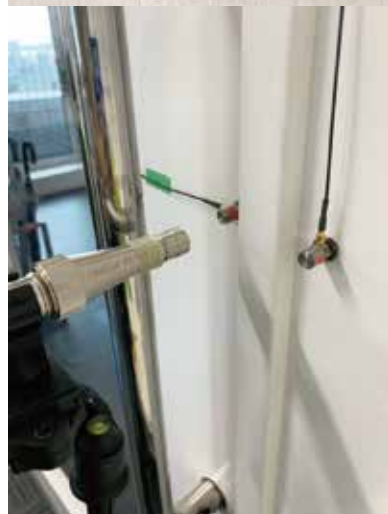
上：現在、研究に取り組んでいる扉の開閉時に発生する加振力・加速度の測定実験の様子。
