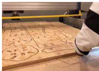
グラスホッパーで設計プロセスを共有、全体像を確認し、NC切削機でリアルサイズを切り出しているところ。
