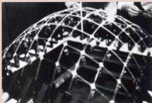
フライアウト型ラチスシェル試験体
