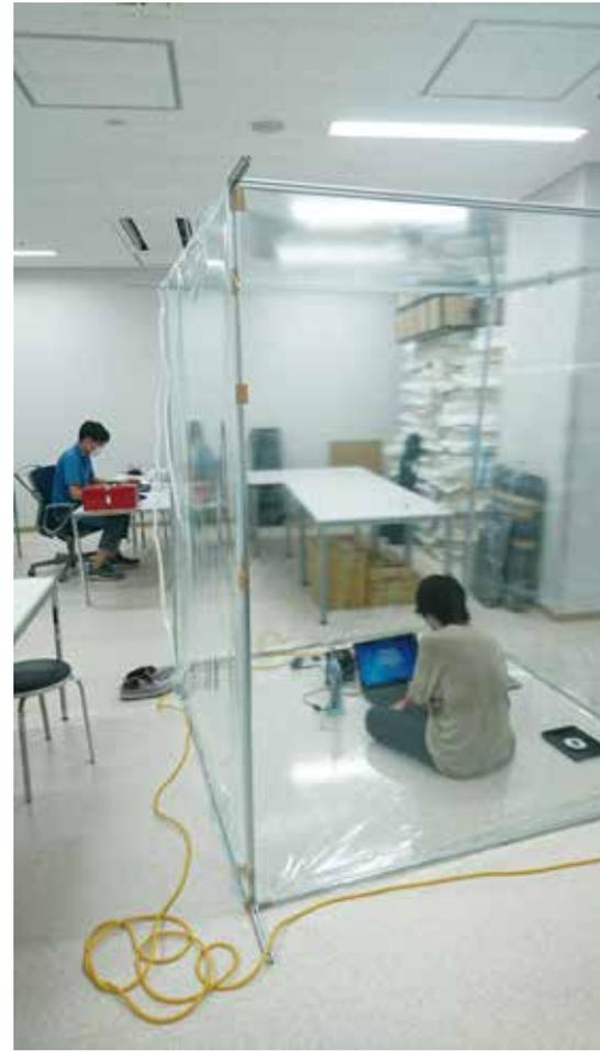
シートで密閉されたボックス内で線香を焚いて粉塵を発生させ、発生量を計測する実験（スコラの実験室にて）。
